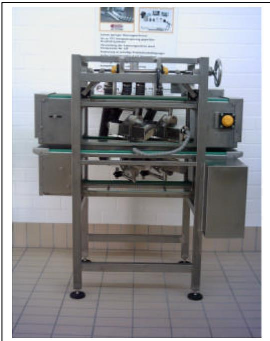
Das Oberband kann über ein Handrad (mit eingebautem Zählwerk) in der Höhe verstellt werden.
