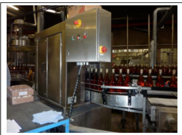
Aufgrund der modularen Bauweise kann das System während des Produktionsbetriebes in die Linie eingebaut werden. Die Wassersammelwanne mit Neigung zum zentralen Ablauf, wird unter den bauseits vorhandenen Transporteur geschoben; das Messerdüsengehäuse wird aufgesetzt und fixiert.
