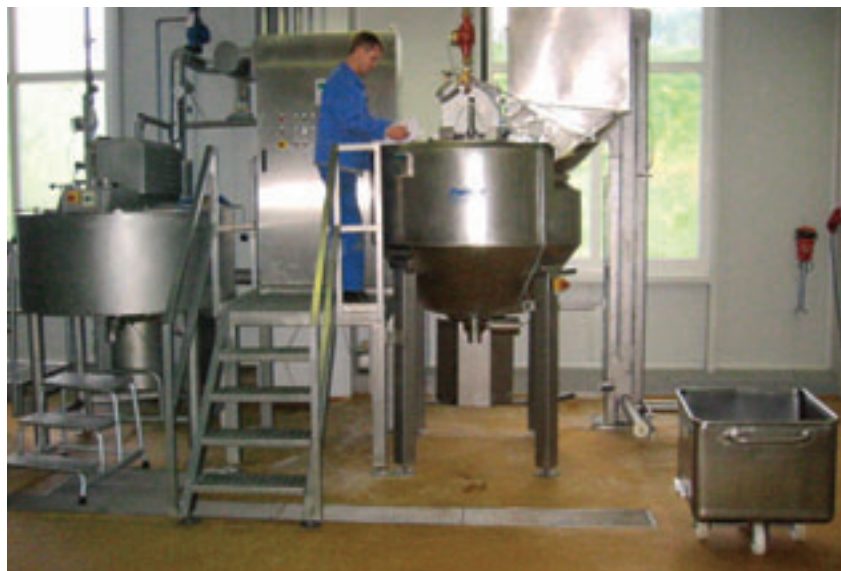
Produktionsanlage für Soßen mit Dispergierer und Anker-Rührwerk
