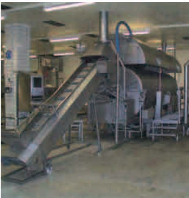
... und eine Blanchieranlage.
