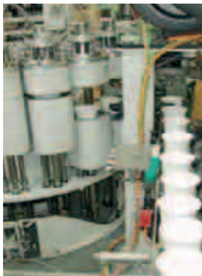
Die Förderschnecke transportiert die Behälter zu den Kammern
