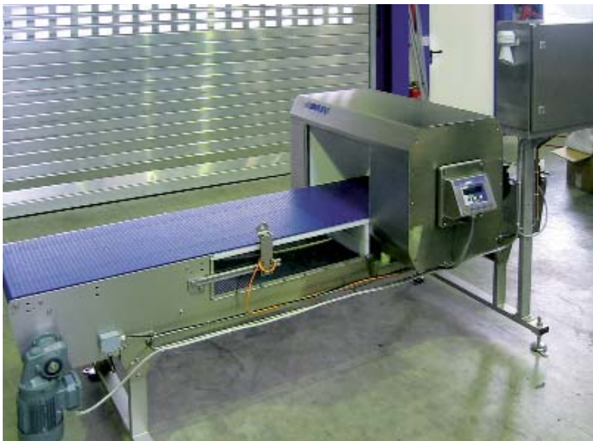
Metalldetektor auf einem Band aufgebaut
