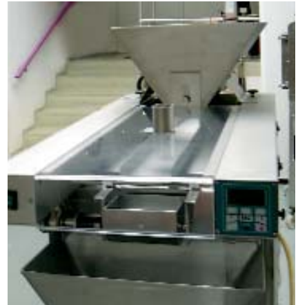
LDS: Dosierwaage in VA-Ausführung für trockene, frei fließende Produkte
