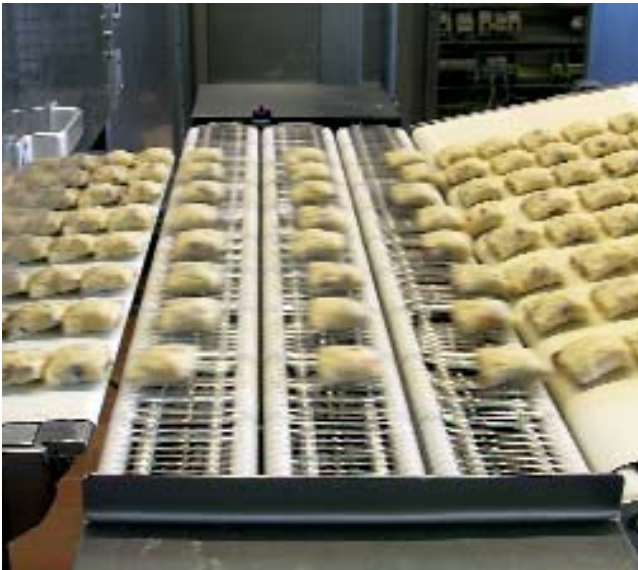
LWS-1400-S: Spezial-Kontrollwaage für Bäckerei- produkte vor dem Backprozess
