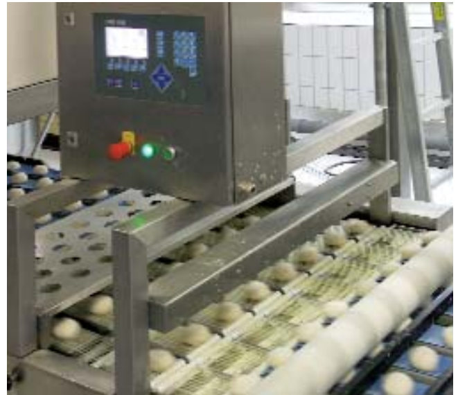
LWS ML-8: Mehrspur-Kontrollwaage für Bäckerei- produkte (8-spurig)
