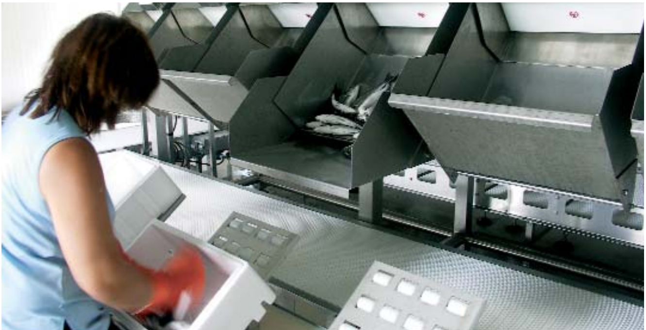
USS Fisch: Wäge-Sortieranlage für Frischfisch
