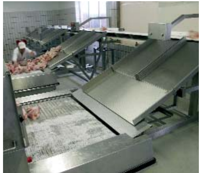
USS Geflügel: Wäge-Sortieranlage für Hähnchen
